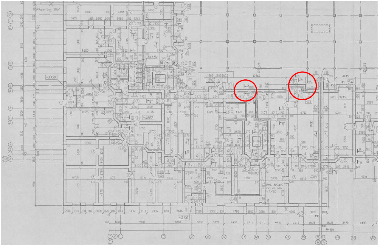
Рис.3. Кладочный план ниже отм. 0,000 с обозначением сечений по общей стене (красными окружностями выделены интересующие сечения)
